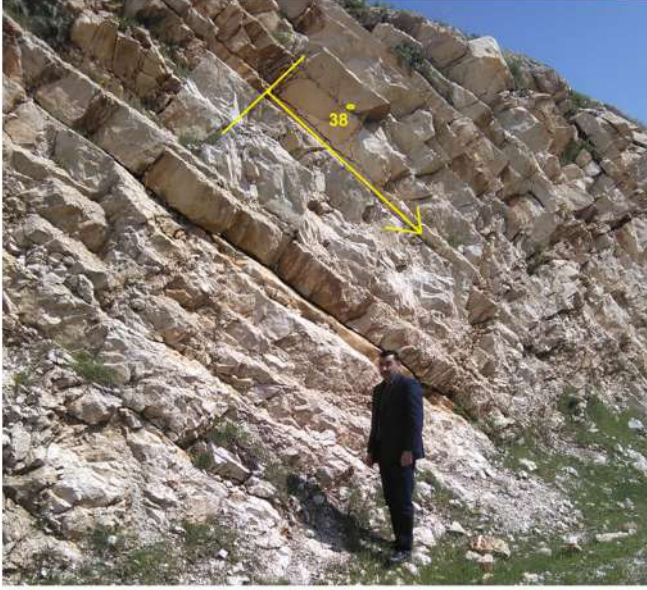
صورة (4) عمليات القطع بشكل يتعامد مع ميل الطبقات الصخرية ( Dip )، السفوح الشرقية لجبل كوسرات
