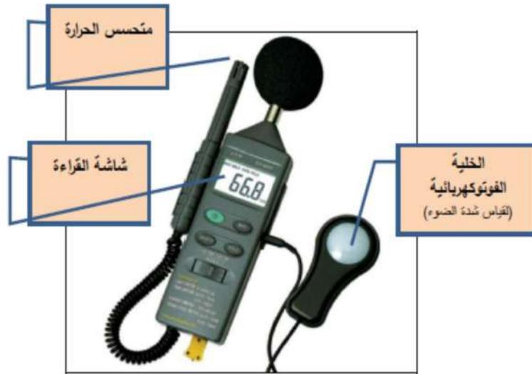
الشكل (٣): جهاز Light Meter CEM DT-8820 لقياس شدة الضوء.
